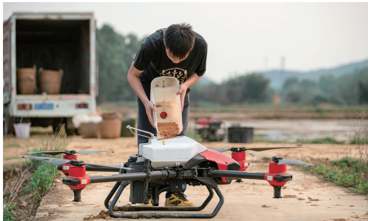
自动化播种前，飞手将水稻种子装入农业无人机电料箱
