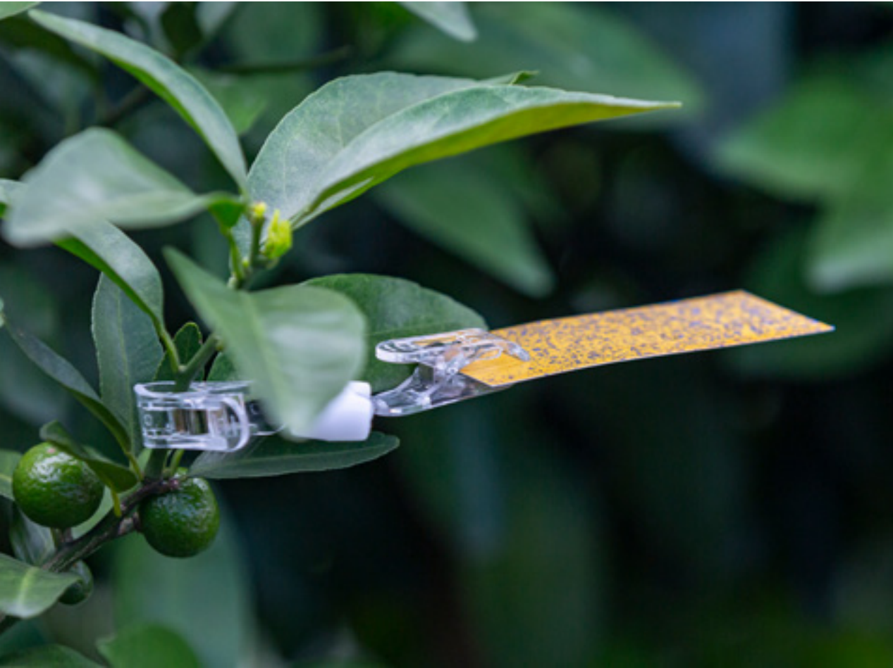
用水敏纸检测无人机果树喷洒质量和农药利用率
