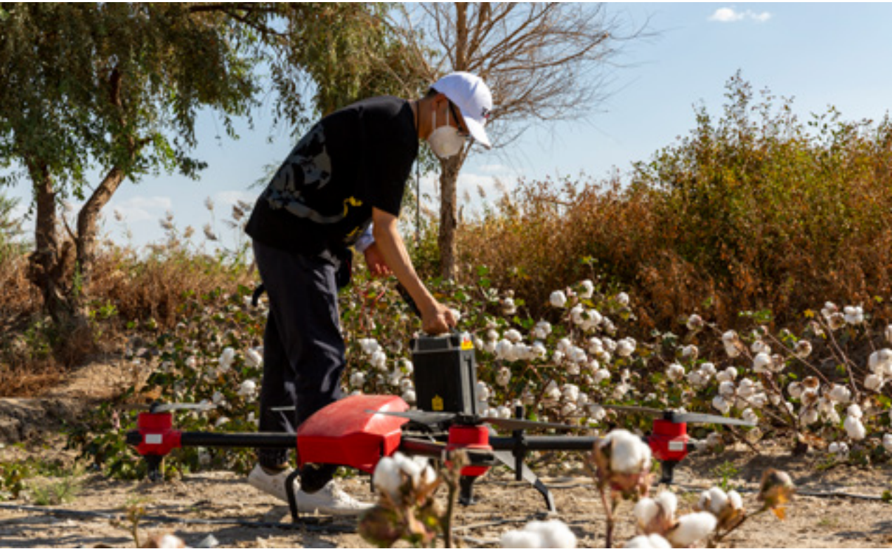
为极飞农业无人机更换电池，用电力代替燃油
